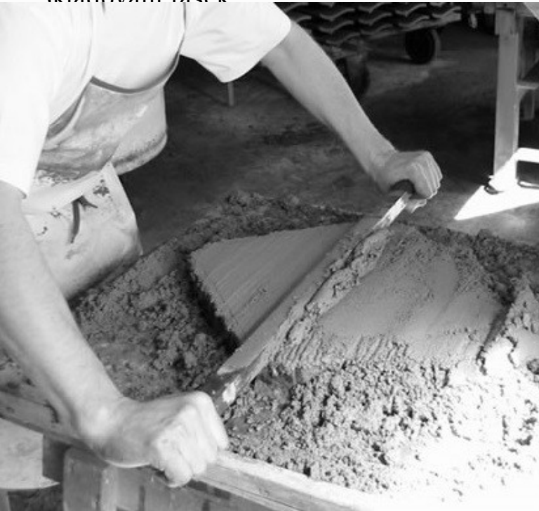
Obr. 1 Výroba kosočtvercové betonové tašky - pracovní stůl Skládování tašek
