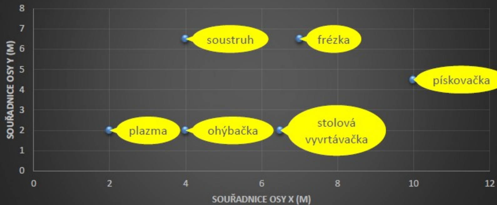
Dispoziční rozmístění stojů výrobní haly KUHN - MT sr.o.
