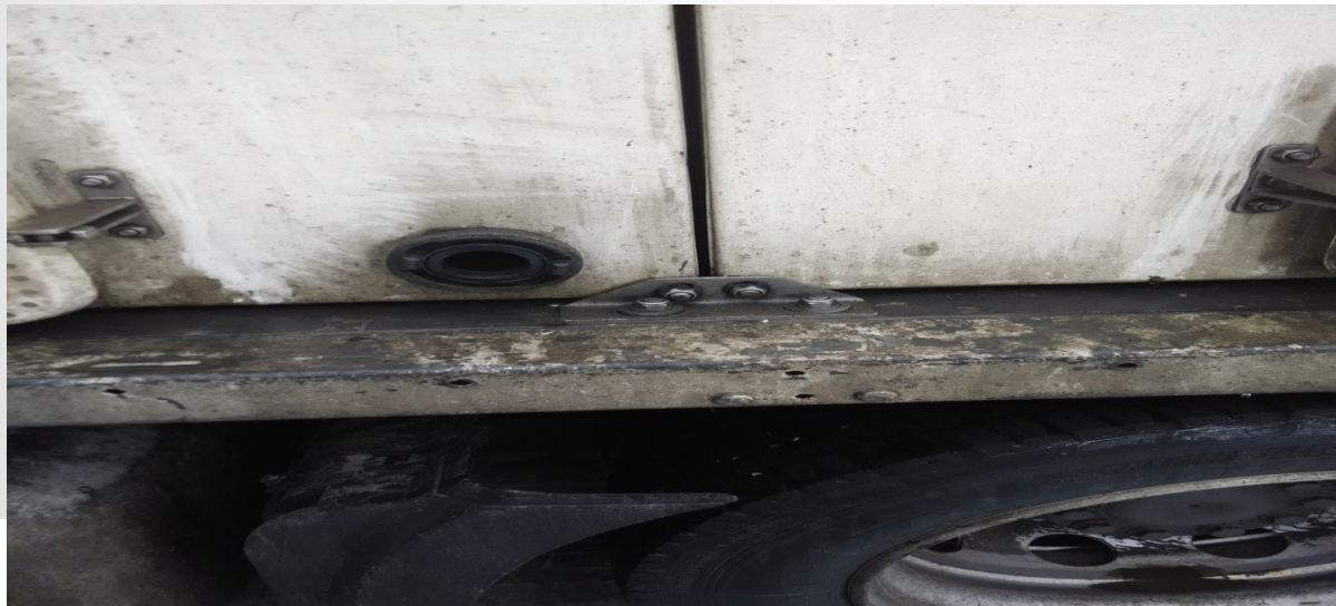
Detail fixace nového kontejneru
