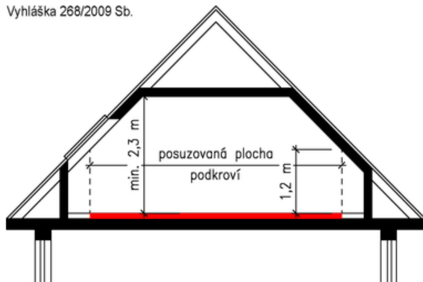
Obrázek 1-1: Výškové uspořádání podkroví obytných budov podle vyhlášky č. 268/2009 Sb.
