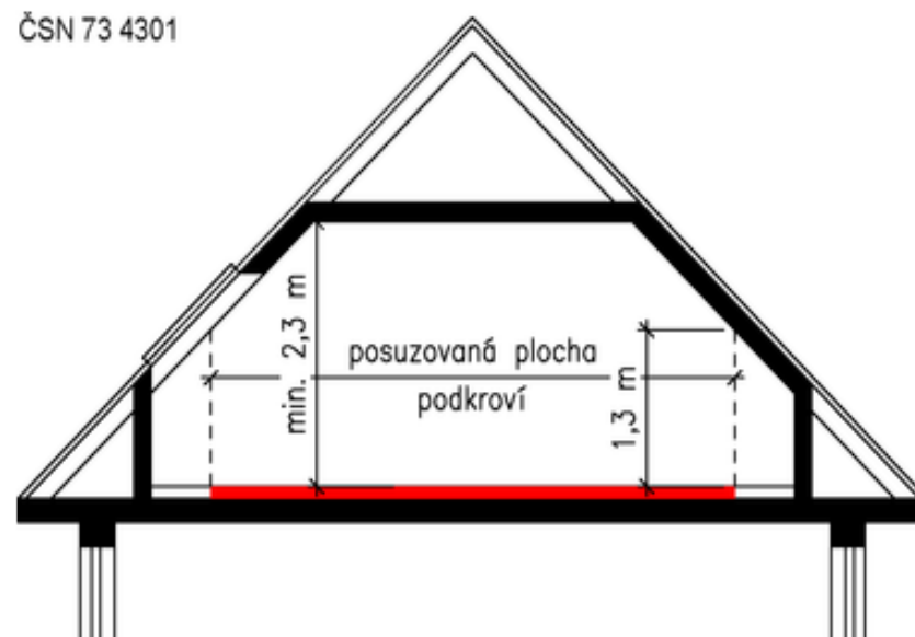
Obrázek 1-2: Výškové uspořádání podkroví obytných budov podle ČSN 73 4301
