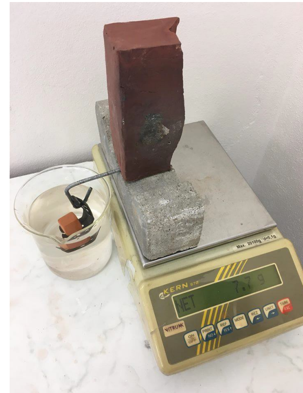
Obrázek 4: náhrada hydrostatické váhy Zdroj: vlastní
