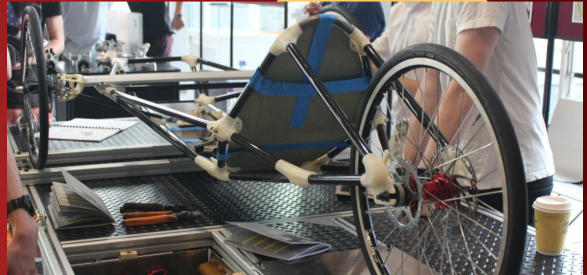
Karbonový rám vozidla pro Shell Eco-marathon, Imperial College London
