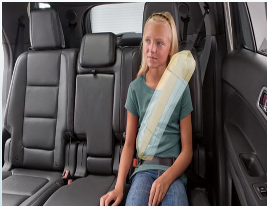
Obr. 1 – Bezpečnostní pás s integrovaným airbagem
