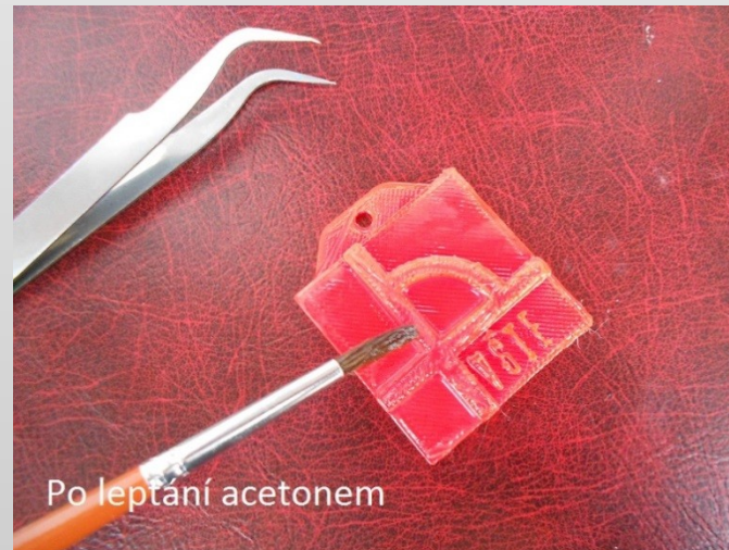
Zkušební vzorek po leptání acetonem (zdroj: vlastní)
