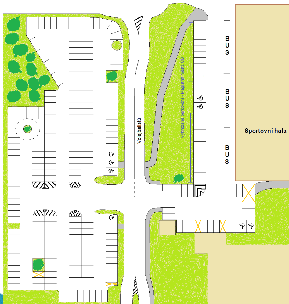
Příloha 9: Návrh opatření - vodorovné dopravní značení
