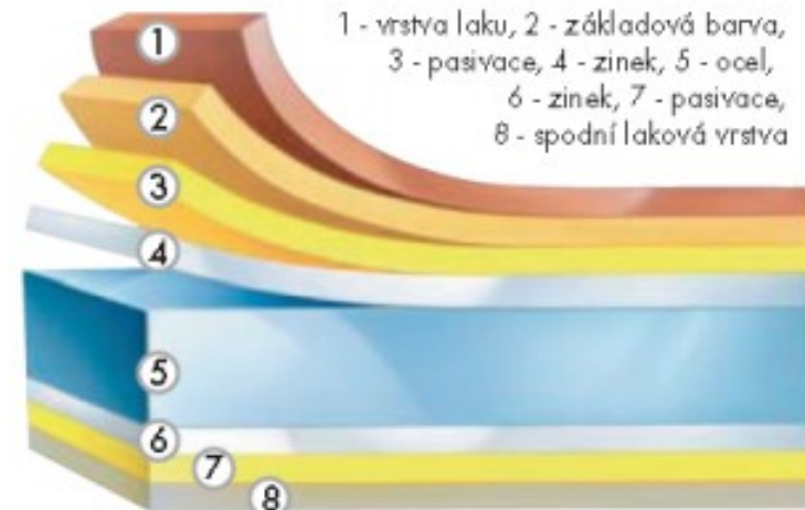
Obrázek č.15 – Složení materiálu pro ohýbané plechy (zdroj: Rebu-stav s.r.o., Co je to tzv. “poplastovaný plech“? [online]. Copyright © 2016 [cit. 2016-05-01]. Dostupné z: http://www.rebustav.cz/co-je-to-tzv-quot-poplastovany-plech-quot.htm )
