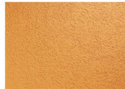
Obrázek č.9 - Zatíraná omítka (zdroj: Tonstav -service s.r.o., Fasády, omítky, potěry Cemix [online]. © 2016 [cit. 2016-05-01]. Dostupné z: http://www.tonstav-service.cz/fasady-omitky-potery-cemix )
