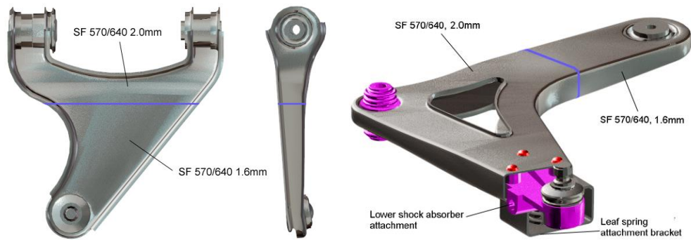
Obr. 8.3 Různé oceli použité při výrobě části podvozku automobilu
