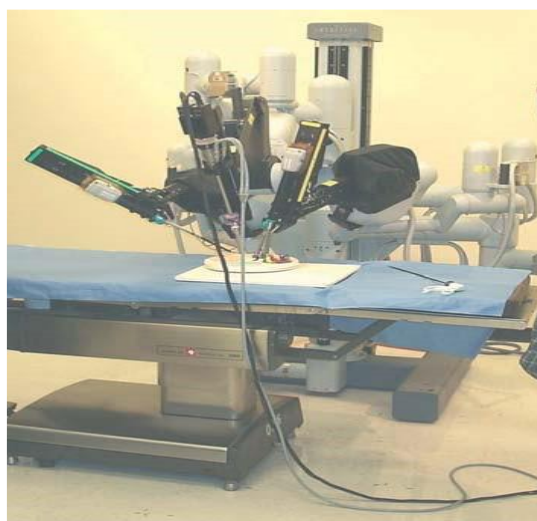
Obr. 12.17 Laparoskopický robotický chirurgický přístroj
