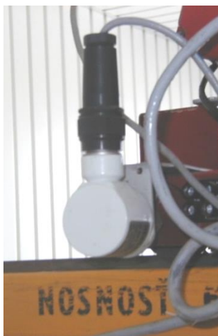
Obr. 13.6 Inkrementální snímač polohy kočky
