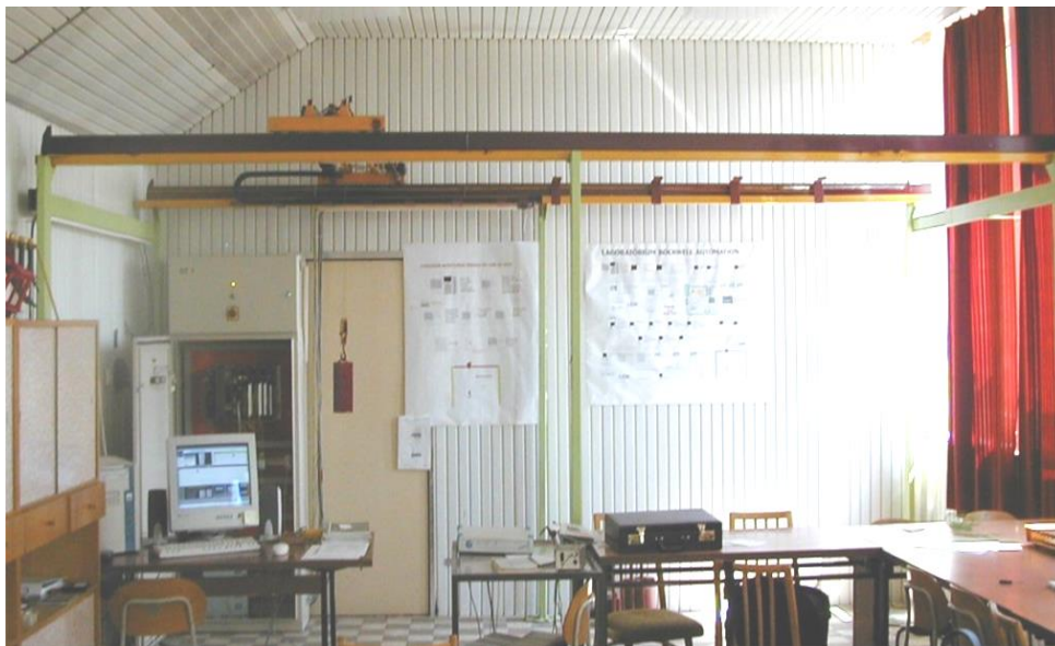
Obr. 13.1 Laboratorní mostový jeřáb
