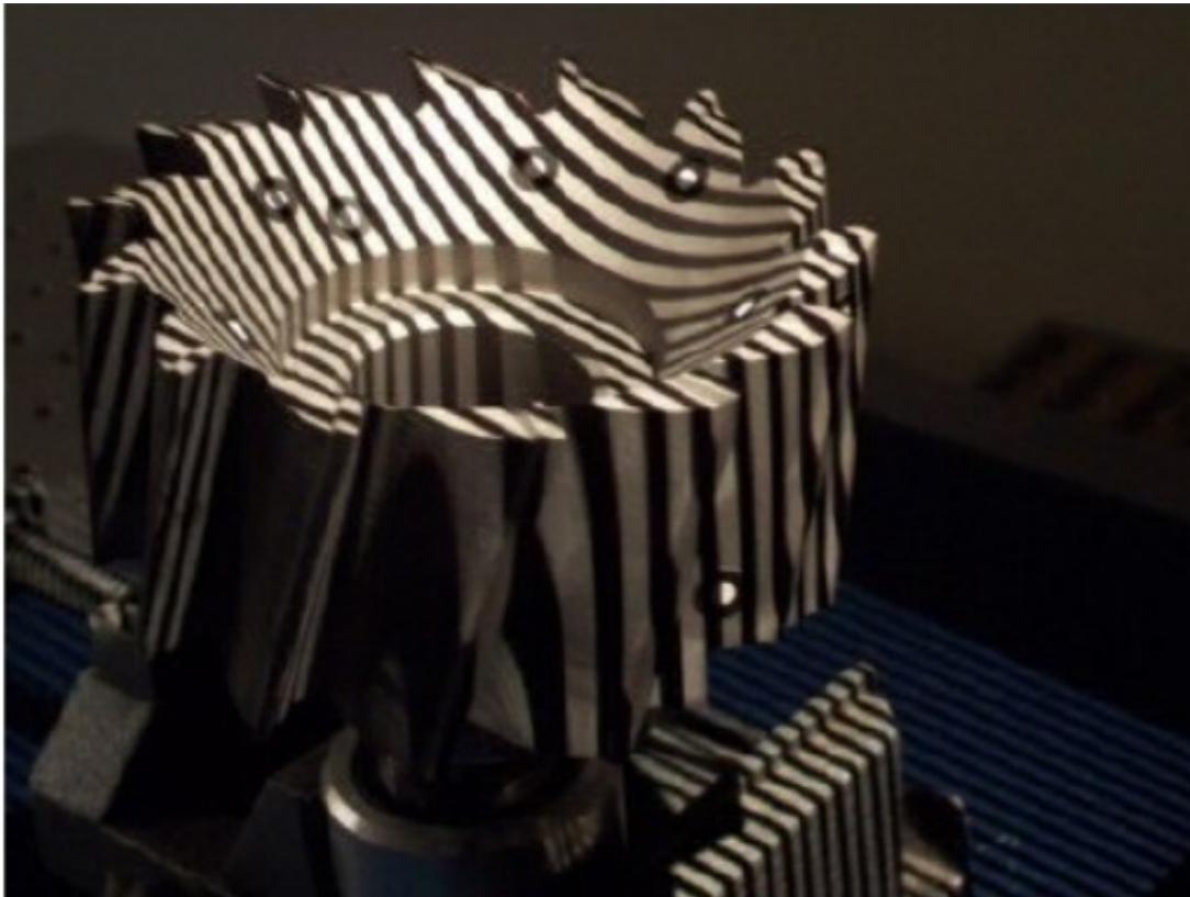
Obrázek 3: Objekt se značkovacími body a promítaným světelným vzorem
