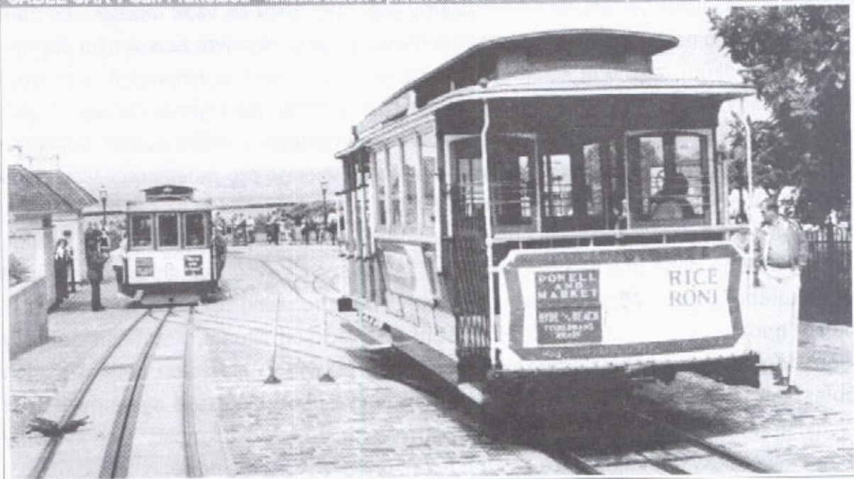
CABLE CAR v San Franciscu - konečná stanice u přístavu Fisherman's Wharf s točnou pro otáčení jednosměrných vozů
