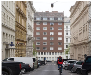
372 Osvětlení na převisech mezi budovami uvolňuje prostor v ulici a umožňuje lepší zacílení osvětlení na střed ulice [ Rakousko, Vídeň ]
