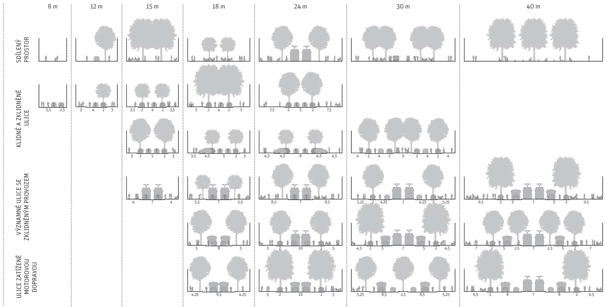
so4 PŘÍKLADY ULIČNÍCH PROFILŮ A CHARAKTERŮ JEJICH PROVOZNÍHO USPOŘÁDÁNÍ Tabulka představuje ukázky možných řešení uspořádání uličních profilů v závislosti na šířce ulice.
