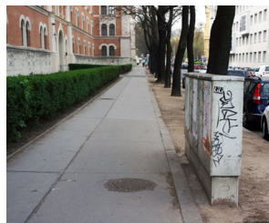
364 Skříň technické infrastruktury může být vhodně umístovat do prostoru výsadbového pásu stromořadí [ Rakousko, Vídeň ]
