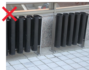
430 Skladné stojany na jízdní kola, které ale nelze snadno použít k uzamčení a které nezajišťují stabilitu kola [ Praha 4 ]
