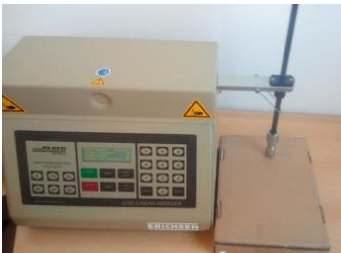
Obrázek 20: Simulace otěru obalů
