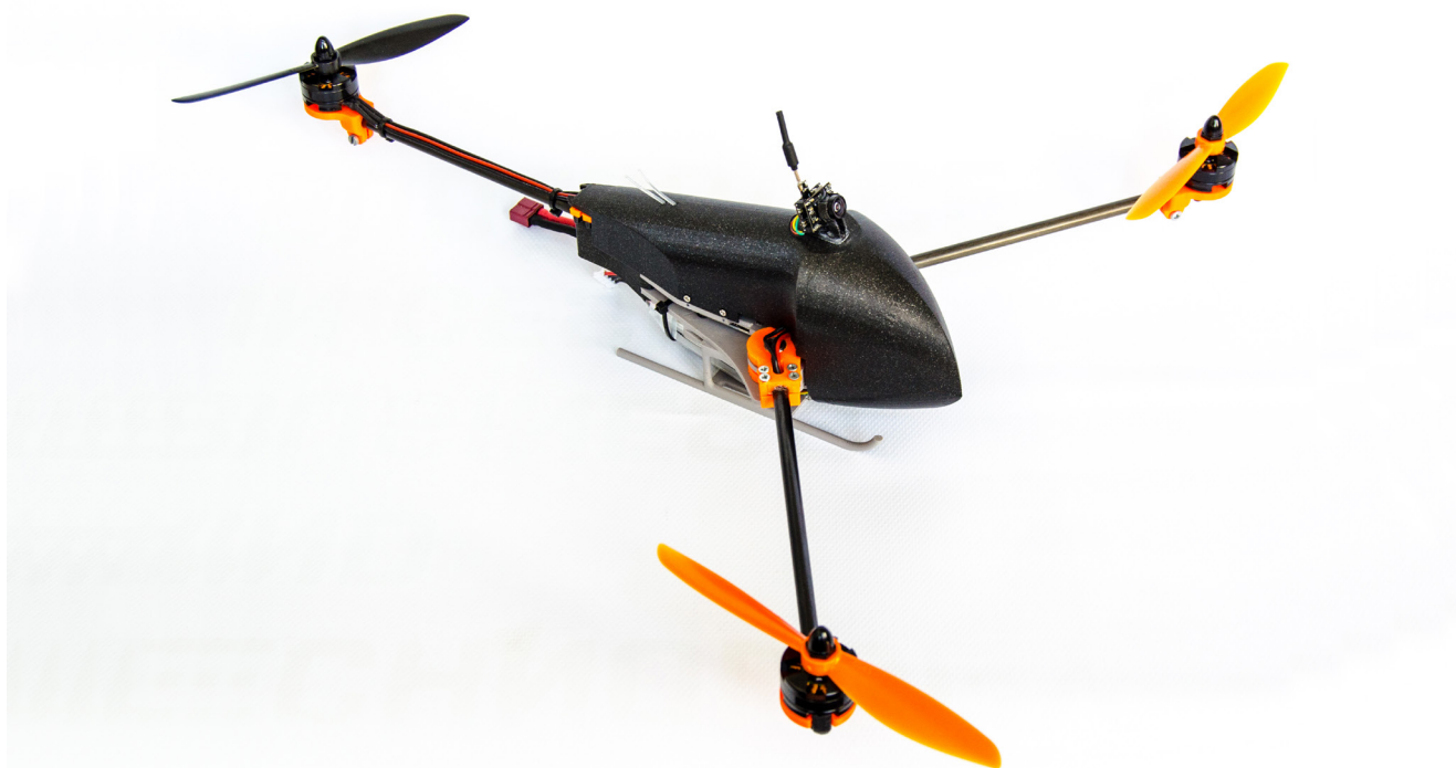
Obrázek 19: Trikoptéra postavená dle vlastního návrhu studentů
