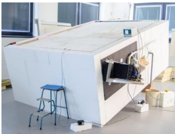
Obrázek 19: Řešení problematiky proudění vzduchu v otevření vzduchové mezeře u dvouplášťových střech pasivních objektů se skládanou krytinou (CZ.01.1.02/0.0/0.0/17_115/0012581)
