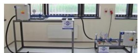
Trať obsahuje proudový vzduchový kompresor (ejektor), doplněný měřicí tratí, umožňující měřit rychlostní profil v potrubí pomocí Prandtlovou sondy. Jako zdroj energie bude použit stlačený vzduch z tlakové nádoby trati č.3. Zapojení umožní provést měření výkonu kompresoru jednak měřením průtoku škrticím orgánem (centrickou clonou), jednak měření rychlostního profilu Prandtlovou sondou. Jako příkon bude měřeno množství a tlak stlačeného vzduchu na vstupu ejektoru.
