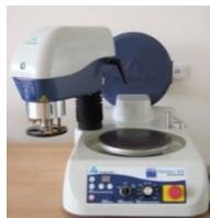
Metalografická bruska a leštěčka (Buehler MetaServ 250 s pracovním kotoučem volitelný  $\varnothing$  200 nebo  $\varnothing$  254 mm. Dostatečně dimenzovaný motor s pohonem řemenem se vyznačuje velmi tichým chodem a zaručuje naprostou stabilitu chodu přístroje i při maximální velikosti vzorků.
