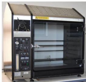
Solná komora VLM GmbH – SAL 400S je určena k testování korozní odolnosti kovových materiálů a povrchových úprav korozní zkouškou solnou mlhou (NSS) dle: DIN 50021 SS, ASTM B 117-73, ISO 9227 a dalších metod a kondensačním testům o objemu komory 400 litrů. Korozní komora je vybavena nádrží na 130 litrů solného roztoku s manuálním řízením.
