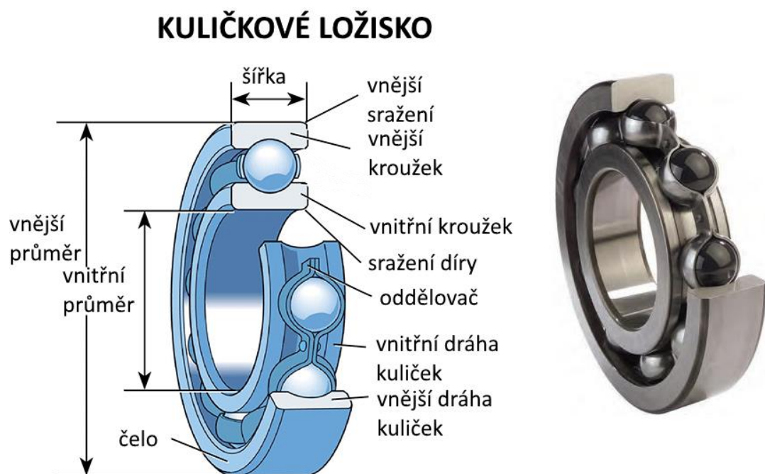
Obr. 12. Kuličkové ložisko (E-KONSTRUKTER, 2015)
