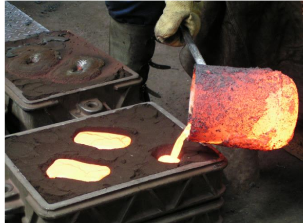
Obrázek – Lítí do netrvalé pískové formy
