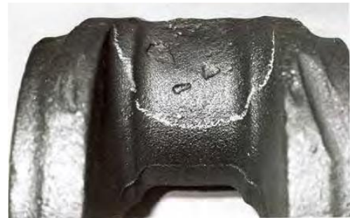
Obrázek – Dutiny na hrubém odlitku z oceli vyvolané zálupy ve vršku formy
