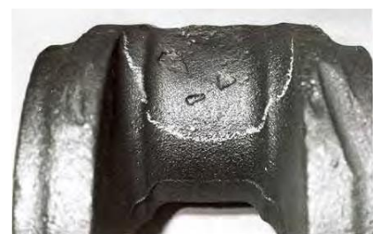
Obrázek – Dutiny na hrubém odlitku vyvolané zálupy ve vršku formy
