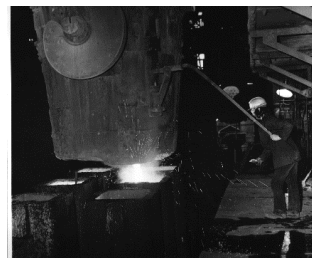
b) Provozní odlévání oceli horem
