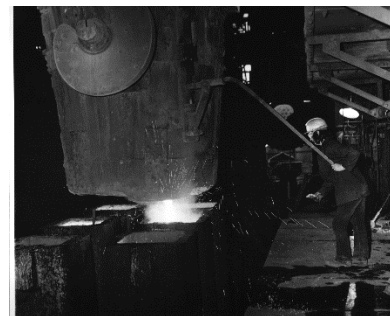
b) Provozní odlévání oceli horem
