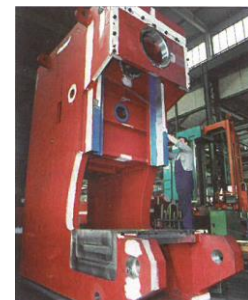
b) Svařovaný rám lisu z jemnozrnné konstrukční oceli
