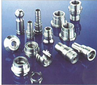
a) Součásti soustružené na soustružnickém automatu
