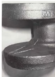
Obrázek – Přesazení odlitku v dělicí rovině
