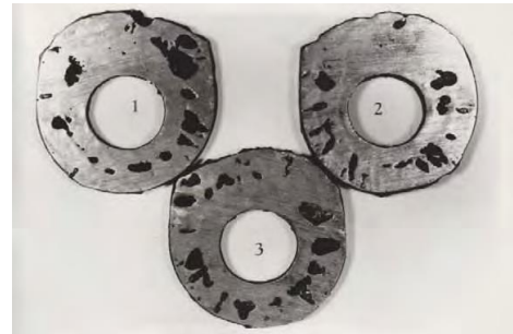
Obrázek – Bubliny ve stěně odlitku
