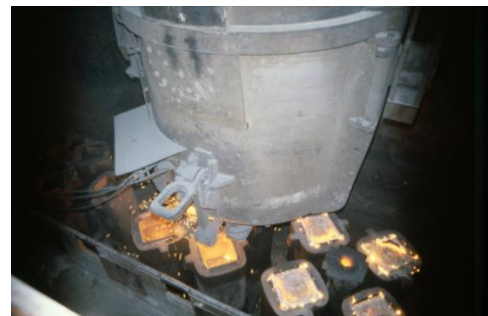
d) Provozní odlévání oceli spodem
