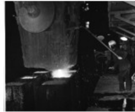
b) Provozní odlévání oceli horem
