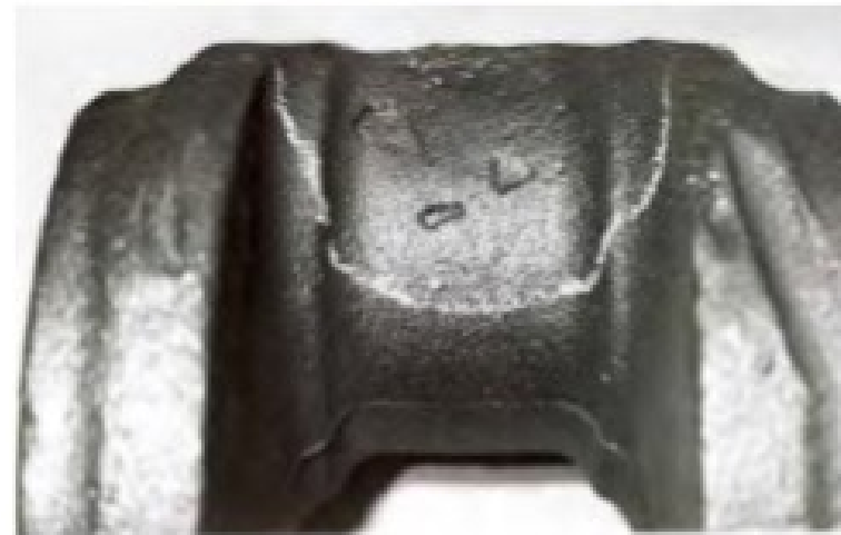
Dutiny na hrubém odlitku z oceli vyvolané zálupy ve vršku formy
