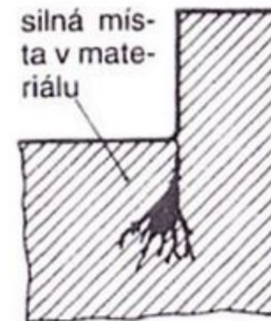
trhliny ve struktuře odlitku
