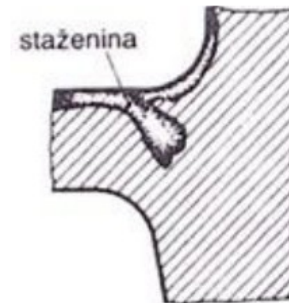
tvoření staženin na místech styku nestejně silných stěn
