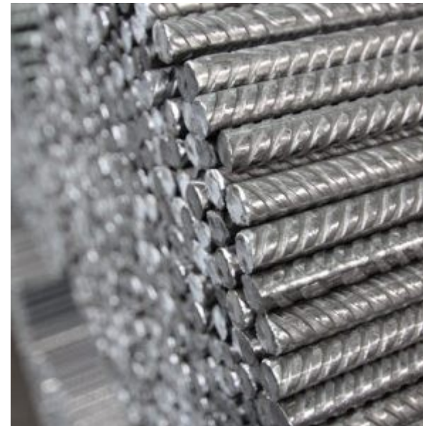
Roxorové tyče (výztuž do betonu)
