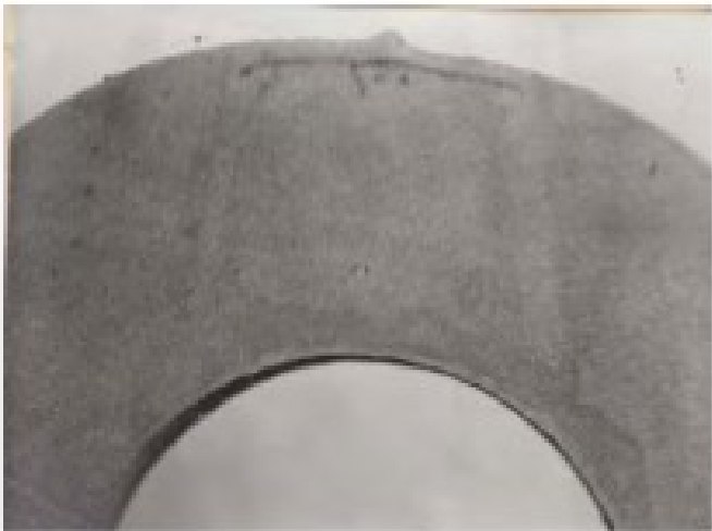
oxidická plena pod povrchem ocelového odlitku
