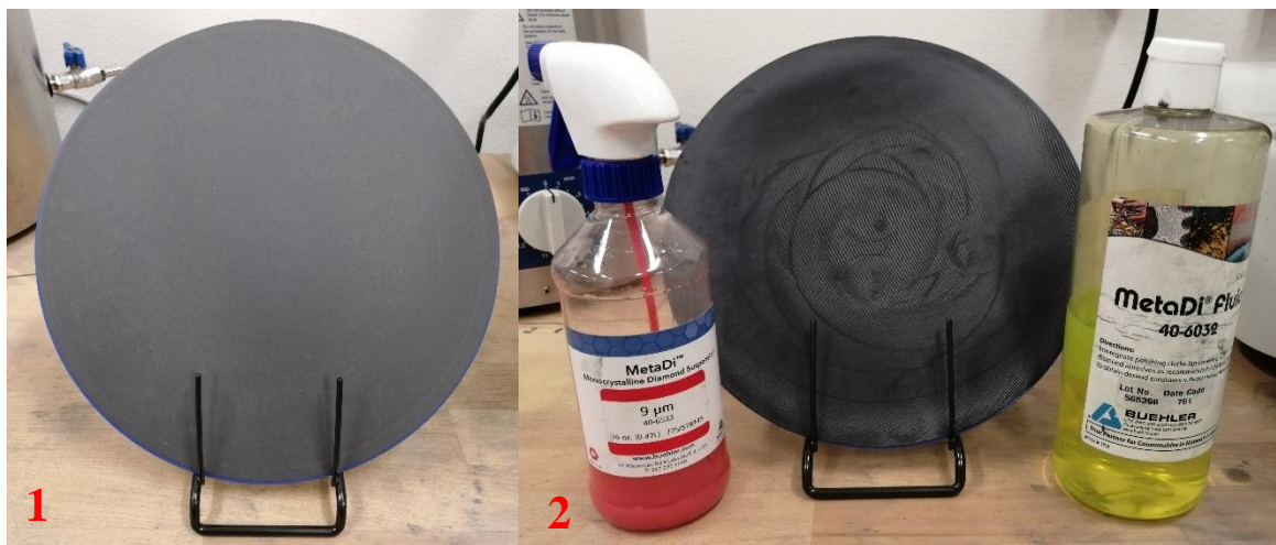
Obr. 10: Krok 1: Brusný papír P400; krok 2: textilní podložka UltraPad, diamantová suspenze MetaDi 9 µm, smáčedlo MetaDi Fluid
