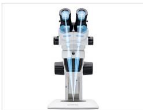
Obr. 1: Stereomikroskop SZ61 s nákresem optického systému Greenough [2]
