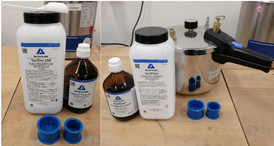
Obr. 5: Modrá zalévací hmota VariDur, tuhne na vzduchu (vlevo); průhledná zalévací hmota VariKleer, tuhne v tlakovém (polymeračním) hrnci (vpravo) s formami o průměru 3 a 4 cm
