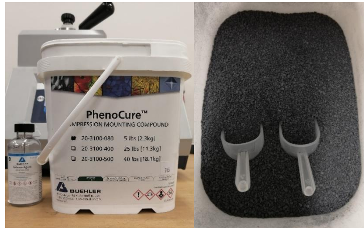
Obr. 7: Zalisovávácí hmota PhenoCure (černá) a uvolňovací činidlo proti přilepení hmoty ke stěně lisovací komory Realease Agent (vlevo)
