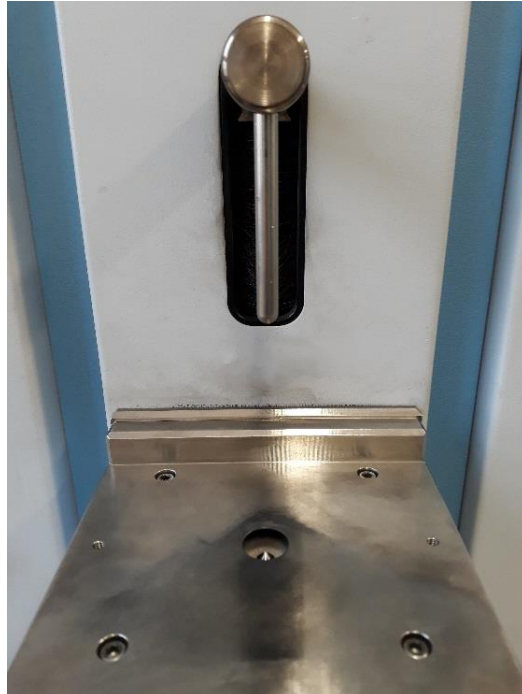
Obr. 15: Analytický stativ, nahoře držák vzorku, dole jiskřiště s elektrodou
