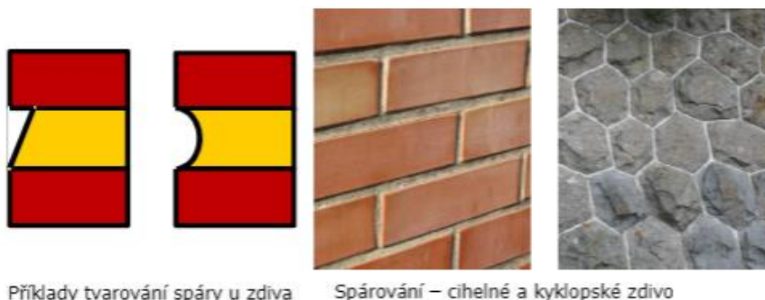
Obrázek 77: Příklady spárování režného zdiva
