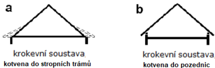
Obrázek 57: Schéma prosté kroevní soustavy
