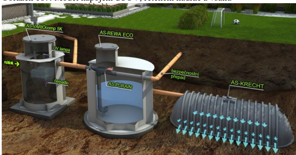
Obrázek 107: Model napojení dČOV, retenční nádrže a vsaku
