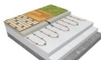
Topné kabely ve vrstvě tepelně vodivého materiálu
