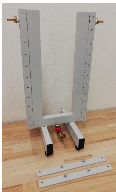
Modely kokil pro studium procesu krystalizace oceli (vytvořeny 2 ks)
