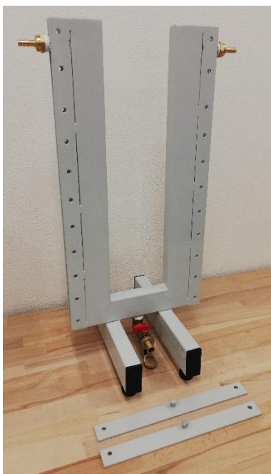
Modely kokil pro studium procesu krystalizace oceli (vytvořeny 2 ks)
