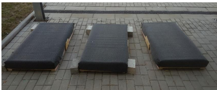
Obr.č.2 – Model s aplikovaným podkladním asfaltovým pásem
