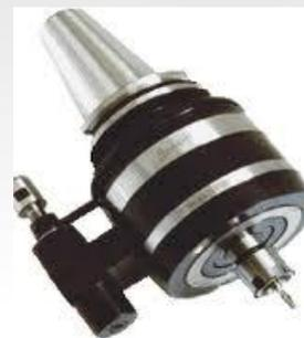
ускорительные головки (мультипликаторы)
