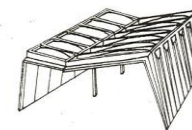
Zastřešení dvou proti sobě opřených oblouků s použitím nosných a sekundárních lan
